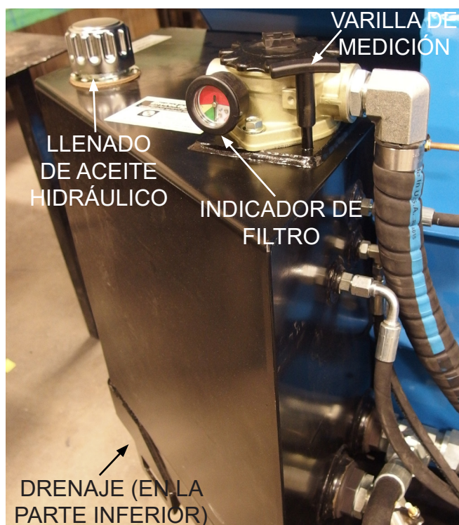
Conjunto del depósito hidráulico
