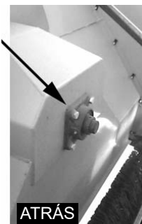
ENGRASADORES EN EL EJE DEL SOPLADOR
