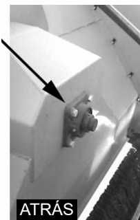
ENGRASADORES EN EL EJE DEL SOPLADOR
