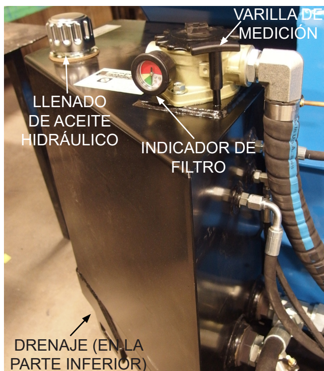
Conjunto del depósito hidráulico
