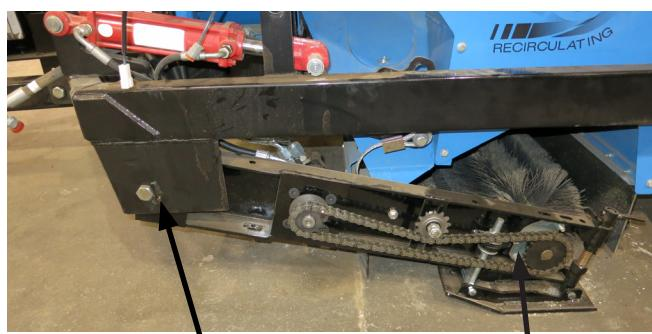
Eje de la bisagra de la cubierta      Eje del rotor
