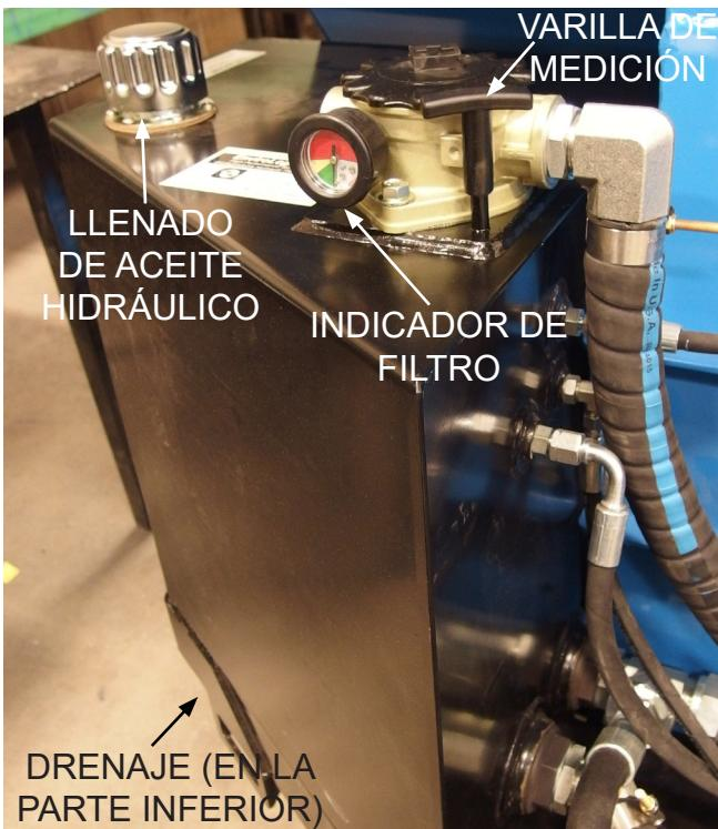
Conjunto del depósito hidráulico
