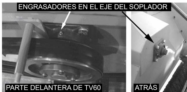
**Nota:** Se debe quitar el blindaje de seguridad para acceder al engrasador en el eje delantero del soplador de **TV60RE**.
