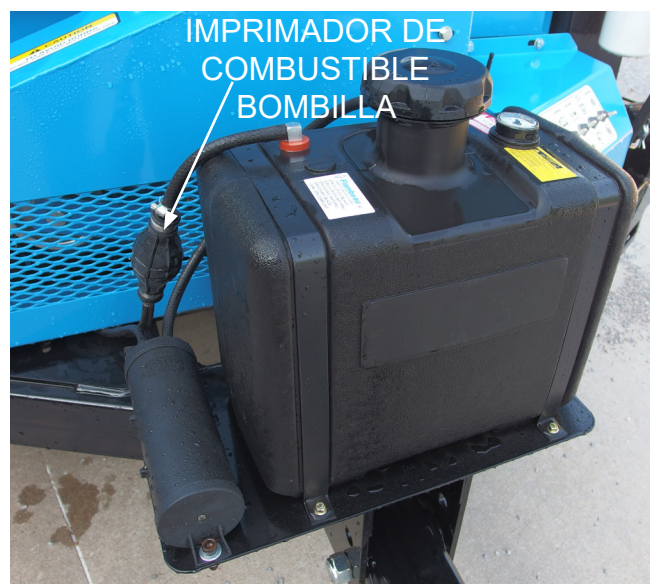
Tanque de combustible
