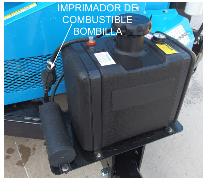
Tanque de combustible
