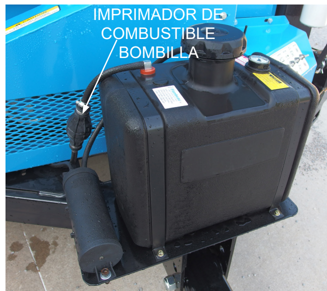
Tanque de combustible
