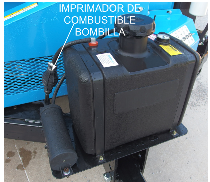
Tanque de combustible
