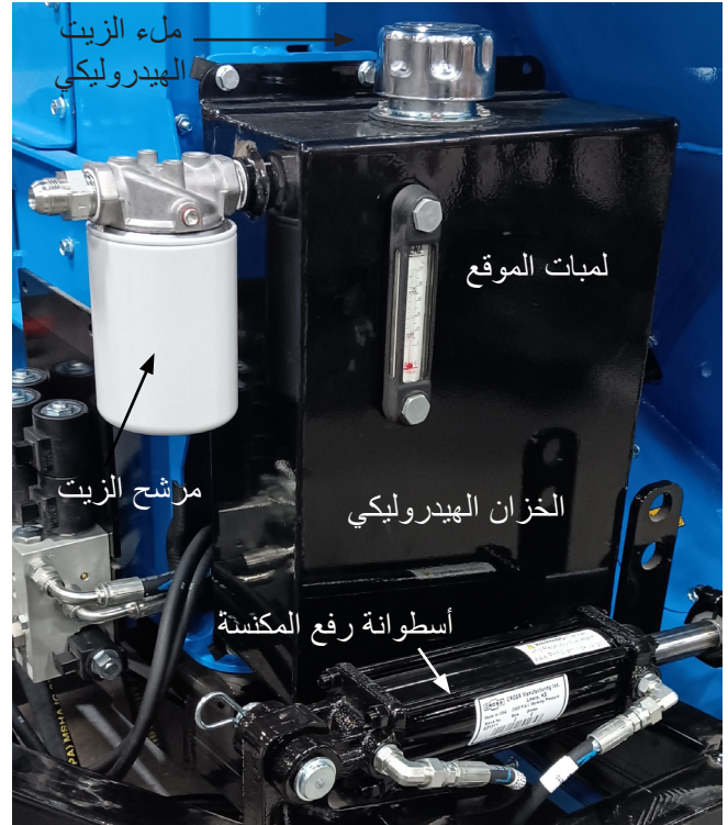
مجموعة الخزان الهيدروليكي
