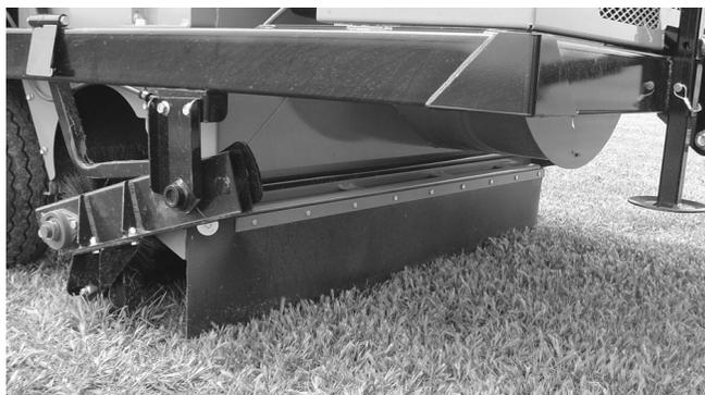
La altura se puede ajustar fácilmente hacia arriba o hacia abajo mediante el gato de trinquete.
