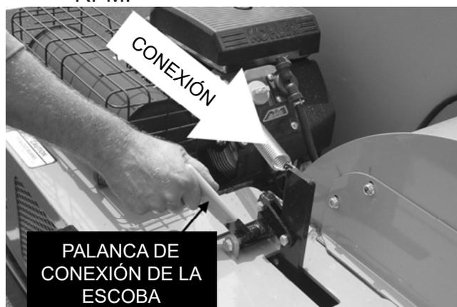
12. Si la unidad tiene una escoba, bájela y conecte lentamente la palanca de la escoba.
