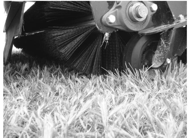
La altura de la escoba está determinada por las ruedas pivotantes en las que se desplaza. La rueda pivoteante se conecta con pernos ubicados en los orificios de ajuste ranurados.
