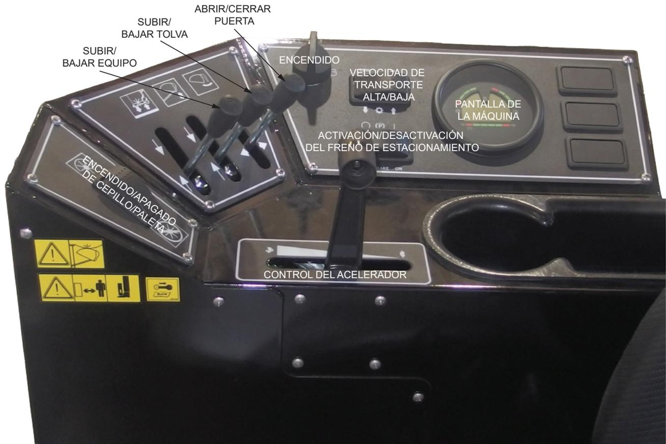
**ENCENDIDO/APAGADO de cepillo/paleta:** enciende la cubierta cuando el motor esté en aceleración de baja a media.
