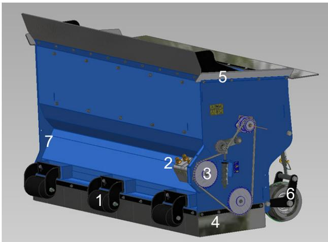
**1. Ruedas antidesbroce:** evitan que el equipo arranque el césped cuando se usa en terrenos irregulares. Estas fueron diseñadas únicamente como ruedas antidesbroce y no para rodar de manera continua sobre el suelo. Consulte la sección Funcionamiento del manual para obtener instrucciones de ajuste.
